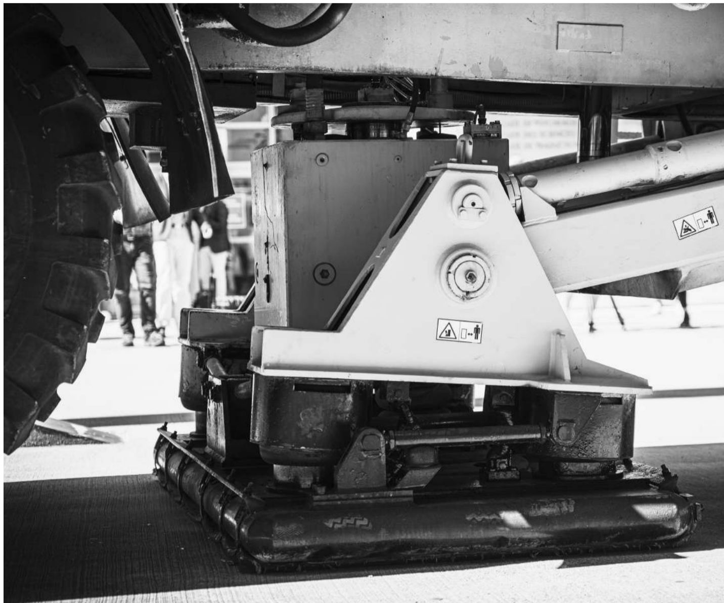
Pour définir la composition du sous-sol, les camions envoient des vibrations dans la terre et captent leurs échos. CÉDRIC VINCENSINI
